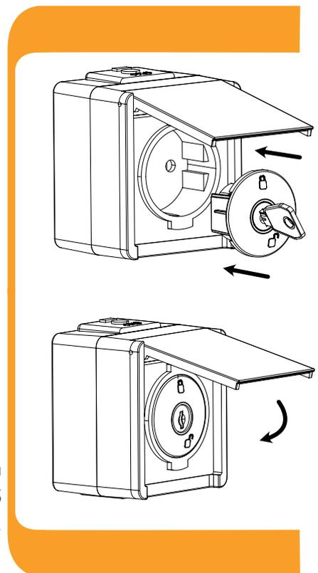
Steckdosen mit Klappdeckel schließen auch mit der eingesetzten SUDHAUS Steckdosensicherung passgenau.
