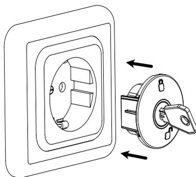
Das Schloss wird mit dem geschlossenen Symbol nach oben bündig in der Steckdose platziert.
