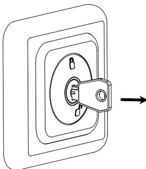
Nach der Verriegelung kann der Schlüssel entfernt werden.
